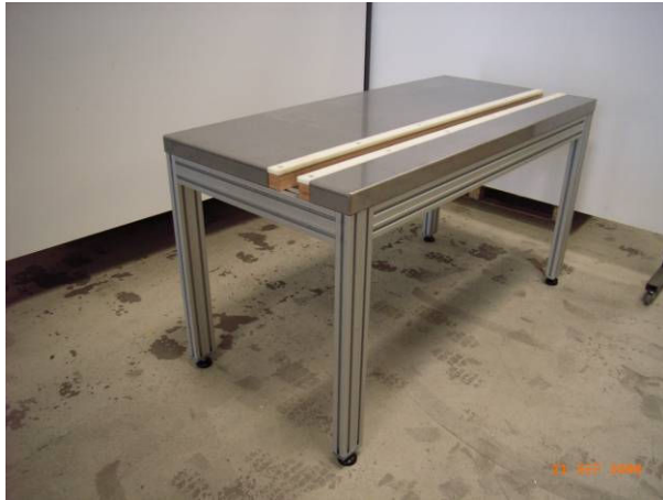
angefertigte Edelstahl-arbeitsplatten mit Holzkern und PVC Verschleißelementen
