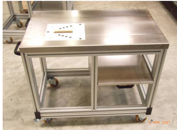
angefertigte Edelstahl-arbeitsplatten mit Holzkern und PVC Verschleißelementen
