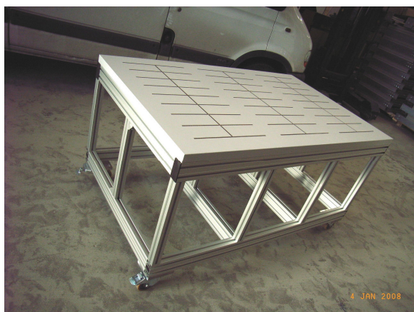
Arbeitsplatte auf Montagewagen mit Einfürungen, um ein Luftpolster zu erzeugen
